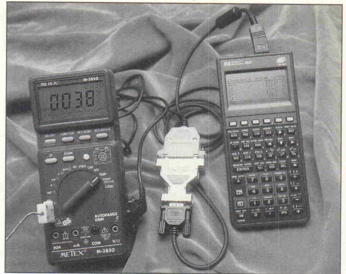
Bild 2. Die Verbindung zwischen dem Metex-Handmultimeter und einem HP48-Taschenrechner ist schnell hergestellt.
